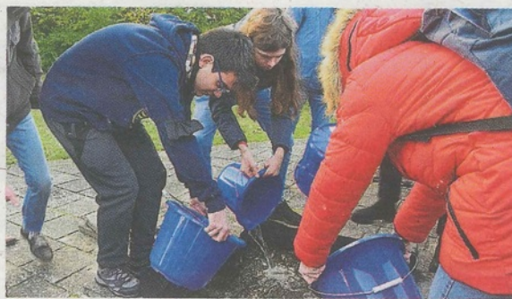
Experimento sobre el infiltrado de distintos tipos de baldosas.
